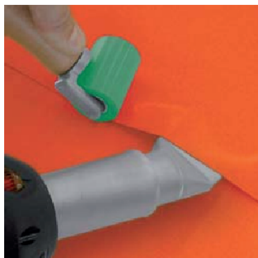
Procesamiento de lonas: Rodillo de 40 mm
